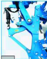
3 Модернизация системы рычагов и их размеров позволило при смещении гидроцилиндра и последующего оборота плуга избежать задевания опорного колеса о землю. Благодаря данному изменению агрегат может максимально выше подниматься над поверхностью земли.
