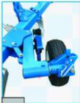
4 Изменение в конструкции кронштейна транспортного опорного колеса по глубине серии LU8 по сравнению с агрегатами серии LK является более простым и практичным; добавлен цилиндр, улучшающий условия оборота колеса. Это дополнение полностью исключило неприятные звуки в момент оборота колеса и ударные нагрузки.
